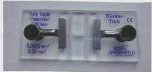
Fig. 4: Een haemocytometer die gebruikt kan worden om de spermacel-concentratie van een ejaculaat te bepalen.
