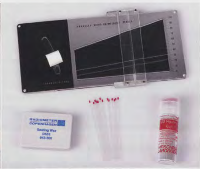
Fig 1b Microcapillairen, kleien, afleesliniaal
