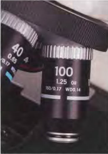
Fig. 4 Afbeelding van een 100X objectief met een numerieke apertuur van 1,25, gecorrigeerd voor een dekglasdikte van 0,17mm (dit is de standaard dekglasdikte) en een werkafstand (WD) van 0,14mm.
