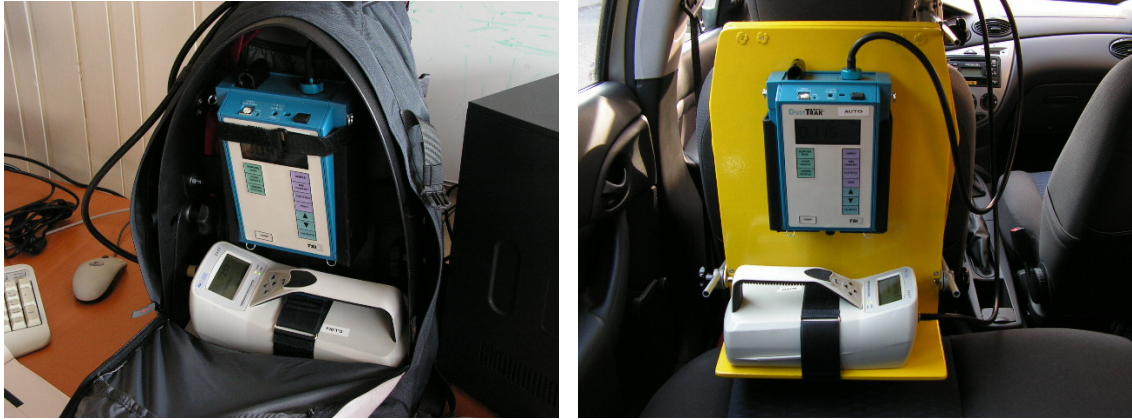
Figuur 3.1a en 3.1b De meetuitrusting voor fietser (a) en automobilist (b) bestaat uit een massameter (TSI DustTrak, bovenste apparaat) en een deeltjesteller (TSI 3007, onderste apparaat)
