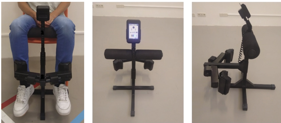
Figuur 3 De Iso-Quad met geïntegreerde krachtsensoren en een scherm waarop de instructies worden gegeven zodat de meting om de juiste manier zelf kan worden uitgevoerd.
