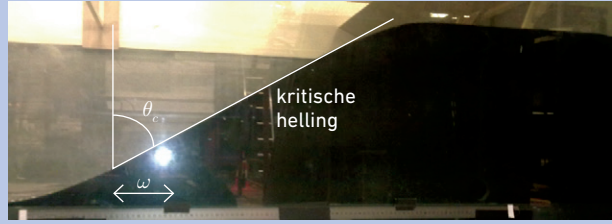
Figuur 2. Conversieloze, eindige-amplitude bodenvorm h(x;\sigma) met lengte, hoogte en breedte van respectievelijk 2,24, 0,42 en 0,5 m, behorend bij een dimensieloze aandrijfperiode T=N/\sigma=\sqrt{2} . De bodem oscilleert horizontaal over 1 cm met frequentie \omega . Interne golfbundels zijn steiler dan de bodem als \theta < \theta_c , waar de steilste bodemhellingshoek \theta_c = 59,4^\circ met de verticaal maakt.
