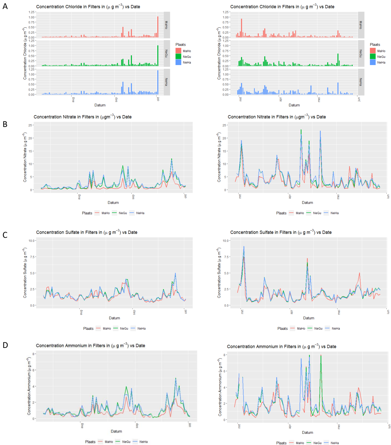
Figuur 15. Verloop van fijnstofcomponenten over de tijd op de meetlocaties in Nederweert (NeHa en NeGu) en Maastricht (MaHo): A) chlorideconcentraties, B) nitraatconcentraties, C) sulfaatconcentraties, D) ammoniumconcentraties. Het verloop over de tijd is zeer vergelijkbaar voor de locaties. Concentraties gemeten in de gemeente Nederweert (NeHa en NeGu) zijn over het algemeen hoger dan op de achtergrondlocatie in de gemeente Maastricht, met uitzondering van de chlorideconcentraties.
