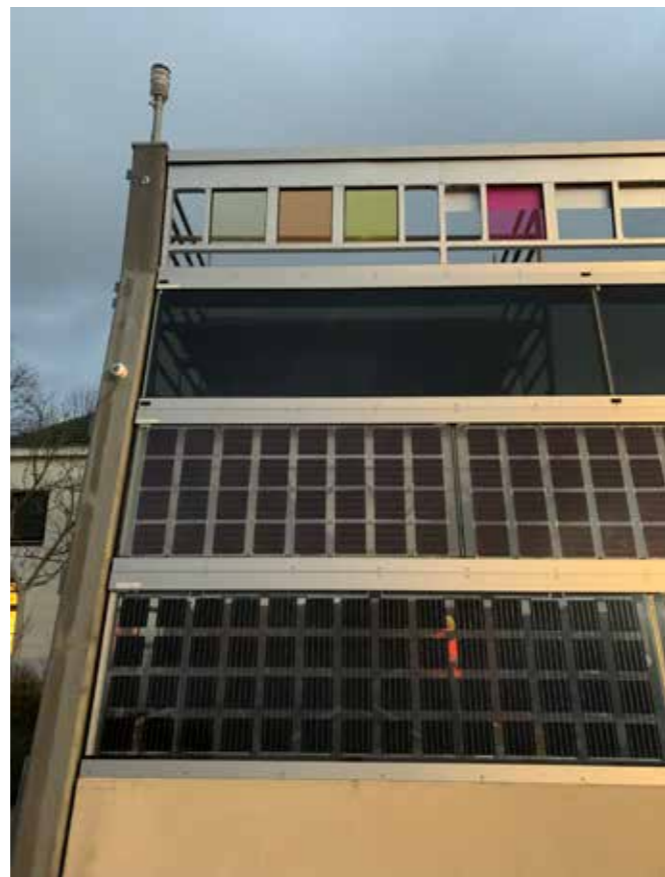
Figuur 3 Test van vijf verschillende LSCs gemonteerd op de bovenkant van een opstelling waarin ook andere zonnecellen worden getest in een geluidswal.
