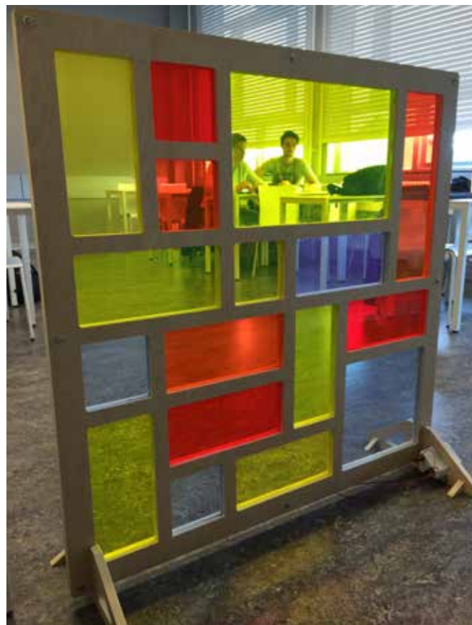
Figuur 2 Twee voorbeelden van de Electric Mondrian. Een combinatie van kleuren, groen, blauw, rood, oranje is gebruikt. In de lijsten rondom de gekleurde plastic platen zijn zonnecellen verwerkt, en niet zichtbaar. De opgewekte elektriciteit kan worden gebruikt om een mobiele telefoon op te laden via een USB-aansluiting.
