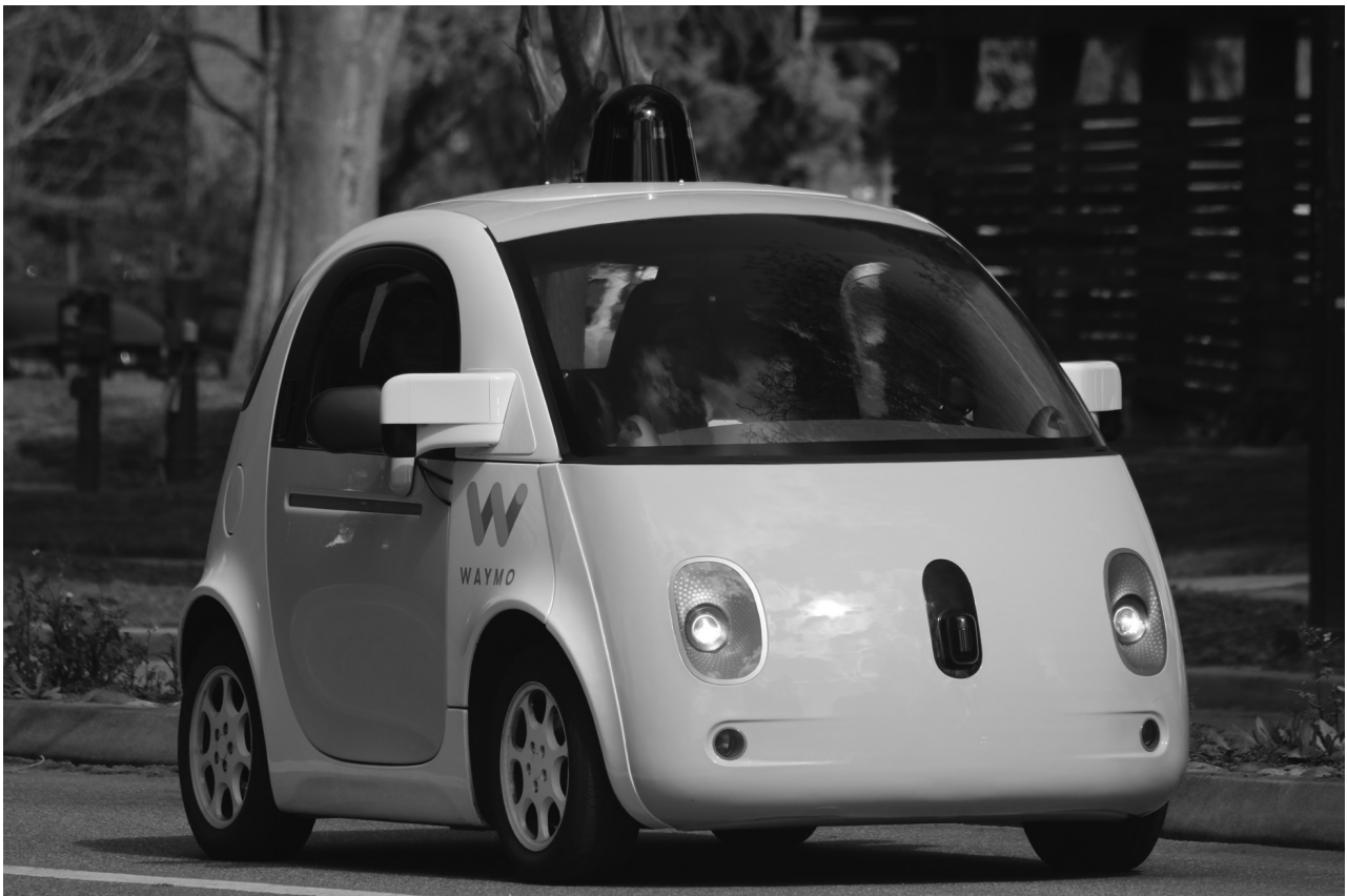
Waymo, de zelfrijdende auto van Google zonder stuur en zonder pedalen Bron: Wikimedia Commons, CC BY-SA 4.0
