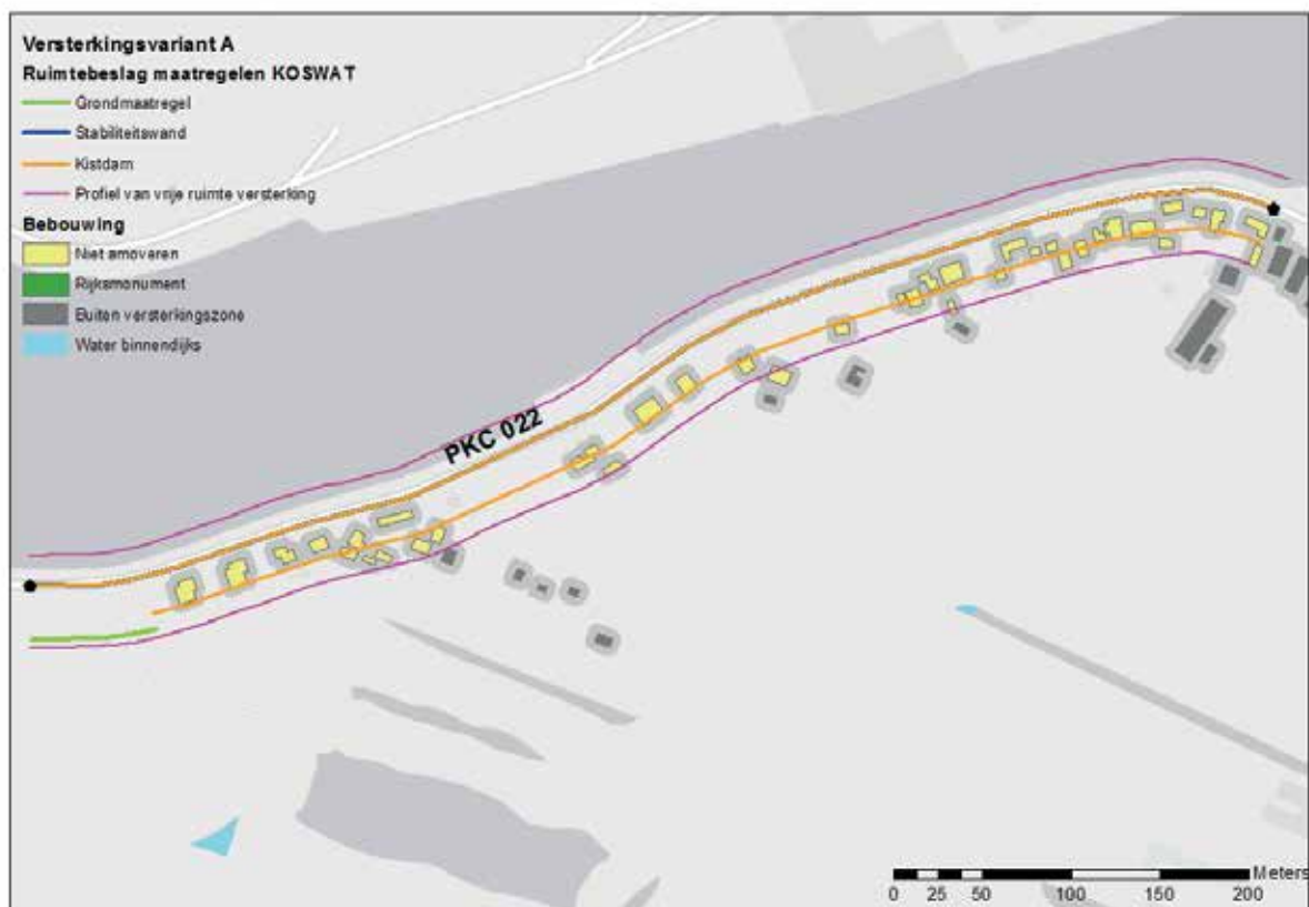
Figuur 1 Dijkversterking met constructies. De oranje lijn die door de geelgekleurde bebouwing loopt stelt de met KOSWAT berekende dijkversterkingsoplossing voor (in dit geval een kistdam). Deze oplossing is geprojecteerd op de huidige binnenteen van de dijk. In werkelijkheid zal de kistdam of diepwand in de kruin van de dijk worden uitgevoerd. Aan de linkerzijde van het dijktraject is aan de groene lijn te zien dat er een beperkt deel van het traject volledig in grond kan worden uitgevoerd. Hier is geen bebouwing aanwezig. De ligging van de groene lijn correspondeert met de nieuwe binnenteen van de dijk.
