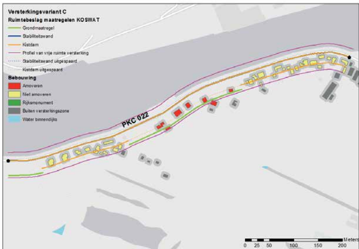
Figuur 3 Gemengde dijkversterking. De geel gekleurde gebouwen blijven gehandhaafd en de dijk wordt daar versterkt met een kistdam, de rood gekleurde meer verspreide bebouwing wordt selectief verwijderd en de dijk wordt daar versterkt met grond.
