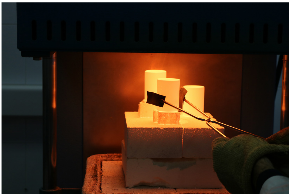
Afb. 1: Het glas wordt uit de oven gehaald. Foto: Thijs Hagendijk.
