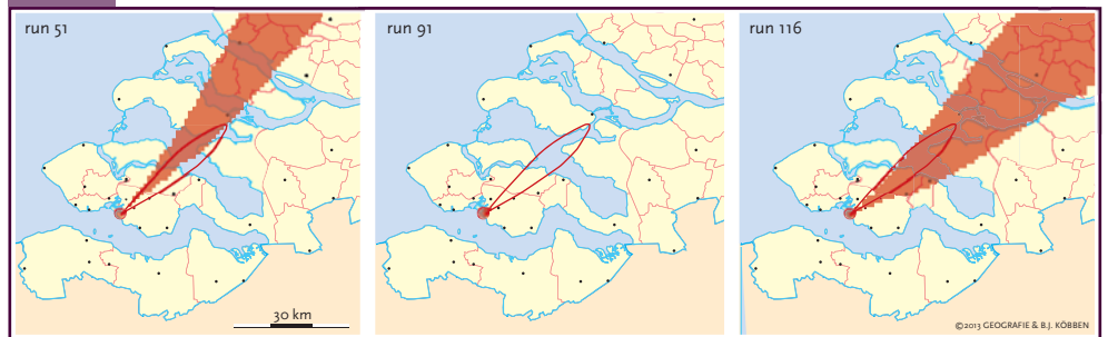
Figuur 5: Modelvoorspellingen voor de overschrijding van de 10 mSv binnen 48 uur. Figuur 5a toont de Monte Carlo-voorspellingen zonder meetnetwerkinformatie; 5b de voorspellingen met één NMR-meetcorrectie na 30 minuten; 5c de voorspellingen met vijf NMR-meetcorrecties van 30 tot 150 minuten na het ongeval.
