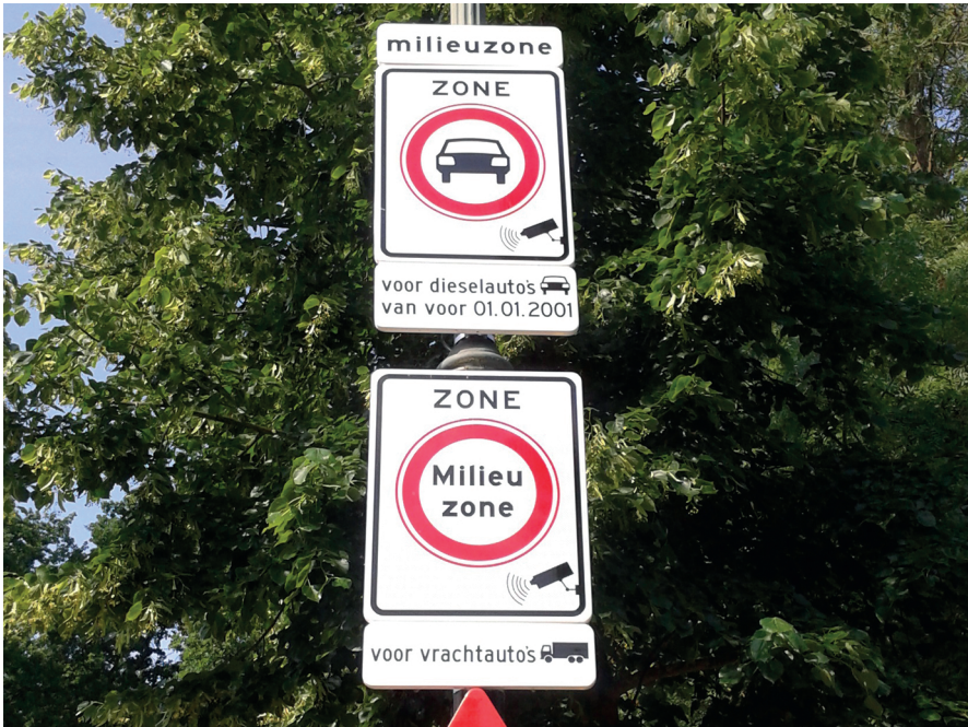
Figuur 3 Een milieuzone waarbij voor dieselauto's een C6-bord met onderbord wordt gehanteerd en voor vrachtauto's een C22a-bord (met onderbord)*
