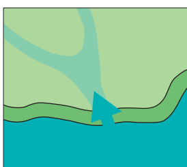
2. doorbraak door piping
