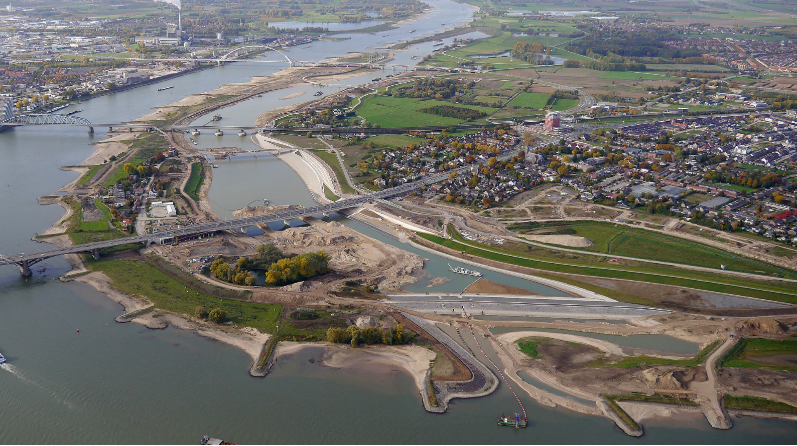
Figuur 1.1. De dijkeruglegging en de aanleg van de nevengeul in volle actie. Goed te zien is dat met deze ingreep de rivier meer ruimte krijgt en de eeuwenoude bottleneck van de Waal bij Nijmegen wordt opgeheven. JRA
