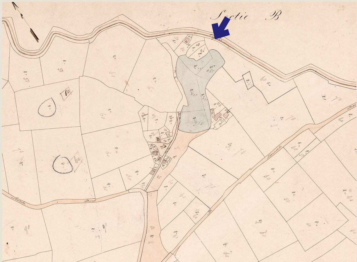
Figuur 7.4. Kaartbeeld van waterbeheersingsstructuren in de Ooij dat het directe verband laat zien tussen een markante crevassegeul, werkend als overloopgeul van de Waal, en de wording van de zijde- en achterwenden in de polders Ooij en Persingen. De Persingensche Dam vormde de voorwende van de polder Persingen, die na de sluiting van de dijkring een rol speelde als waterkering van de regionale afwatering rond het Meer, later ook fungerend als waterbergingsgebied. Naar Keunen & Willems 2010, De Koning e.a. 2009.
