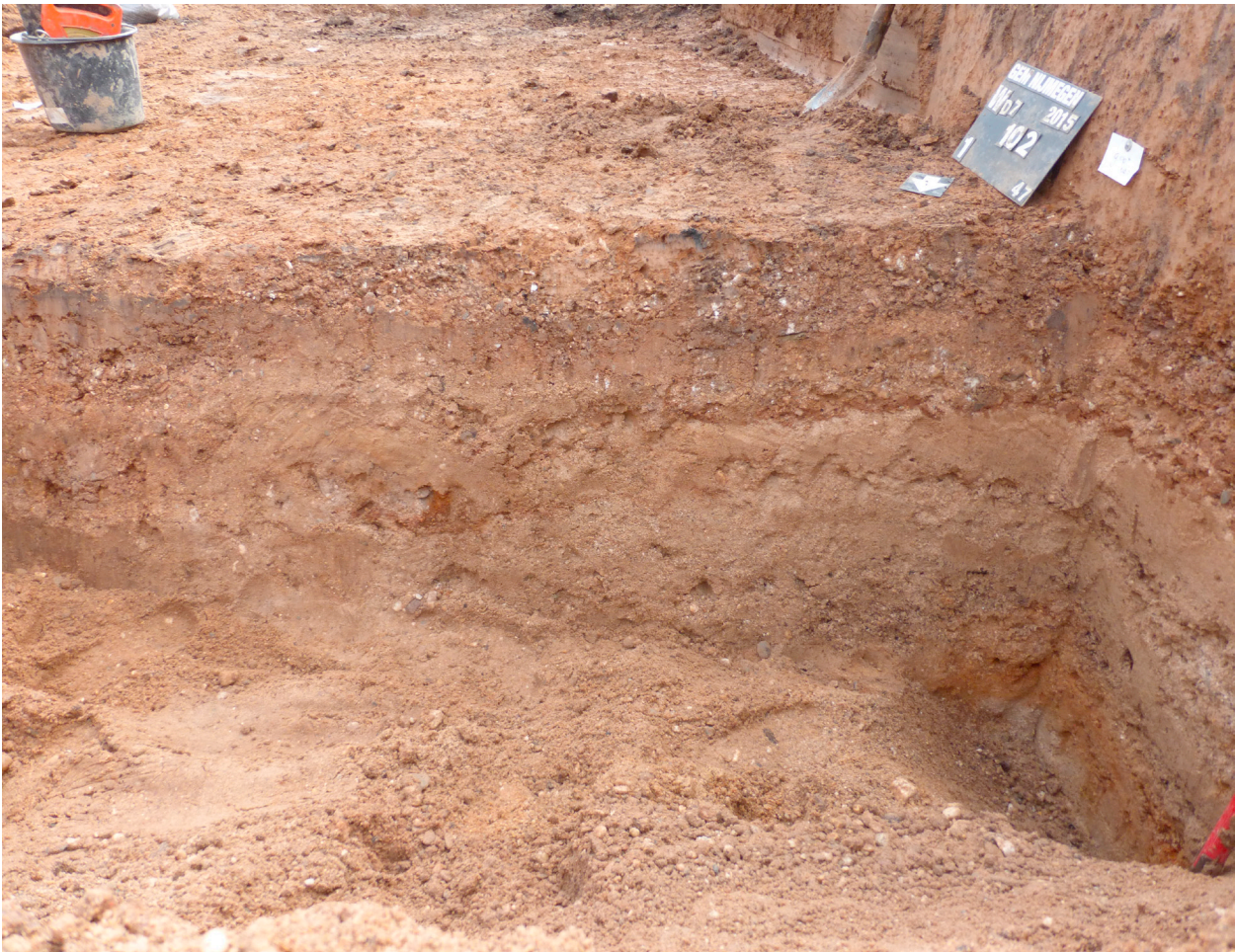
Figuur 2.8. Bodemontsluiting van de top van het Laagterras tijdens de aanleg van een nieuw riool onder de Weurtseweg (Nijmegen). De top van de grindrijke rivierafzettingen ligt hier rond 8,5 m +NAP en wordt afgedekt door een dun pakket holocene klei. EH
