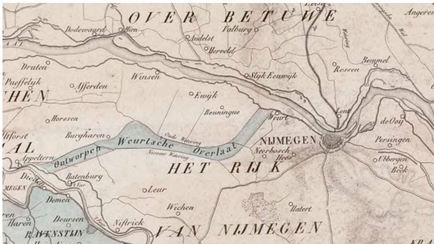
Figuur 9.4. Fragment van een kaart uit 1827–1828, waarop ontwerpen van rivierafleidingen staan aangeduid. Hier zien we een overlaat bij Weert. Bij opstuwing van Waalwater door ijssdammen kon het via die overlaat en een groene rivier in het komgebied van het Land van Maas en Waal naar de Maas stromen. De ideeën over rivierafleiding zijn symbolisch voor het disfunctioneren van de dijk in de eerste helft van de 19 e eeuw. GA
