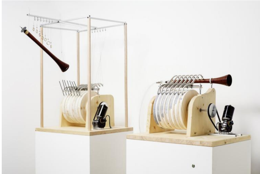
Afbeelding 16. Een mogelijke reconstructie van de muziekautomaat van de Banu Musa. Links staat het mechanisme om het muzikaal programma in de trommel aan te brengen, rechts staat het speelwerk (uit Berlin 2015, p. 92).
