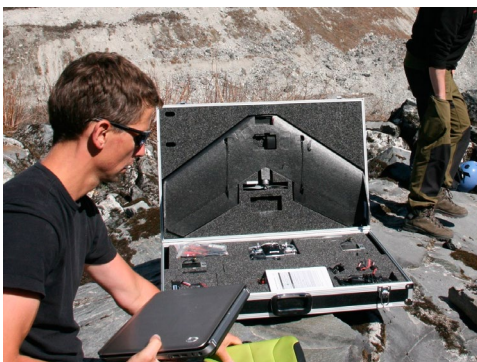
Figuur 5a: de SenseFly Swinglet UAV in zijn koffer. Deze UAV is gebruikt om de foto's van de Langtang gletsjers te verzamelen.
