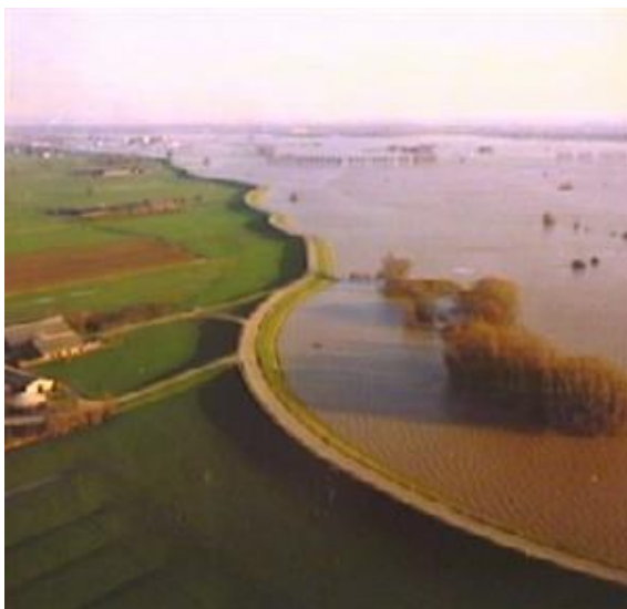
Foto 1. Suspensief transport kleurt overstromingswater in de uiterwaarden van de Nederrijn bruin. Hoogwater 1995, Wijk bij Duurstede, nabij km 924.700 rechter oever.
