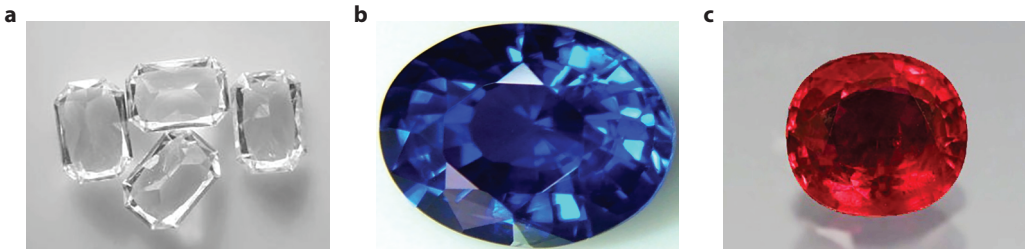
II • Het doteren van isolatoren. (a) Puur alpha-aluminiumoxide, oftewel corundum, is een isolator die kleurloze kristallen vormt. Interessante optische eigenschappen krijgt het materiaal pas als het wordt gedoteerd, d.w.z. als er een kleine hoeveelheid (<1%) van een vreemd element wordt ingebracht. (b) Gedoteerd met titanium en ijzer staat het materiaal bekend als blauw saffier. (c) Gedoteerd met chroom heet het materiaal robijn. Bron: jiyunjung.blogspot.com.
