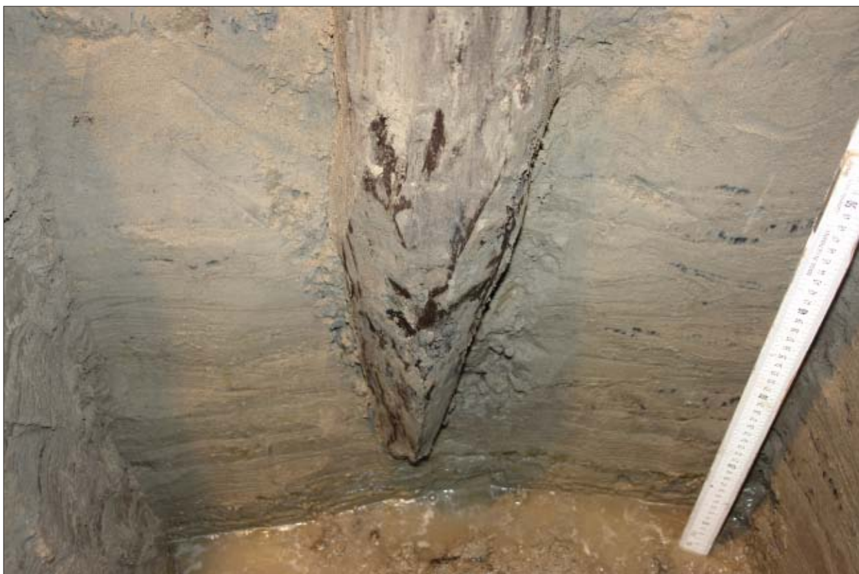
Afb. 2.3 Romeinse paal met natuurlijke bodemopbouw en horizontaal gelaagde rivierafzettingen.
