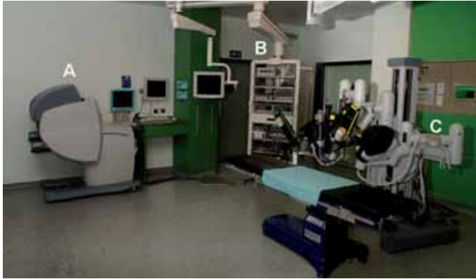
Figuur 3 - Het Da Vinci® robotsysteem bestaande uit de console (A), de kar met elektronische apparatuur (B) en de robot (C) (Voor kleurenfiguur zie pagina 292).
