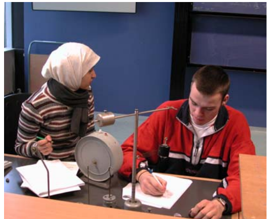
Leerlingen in het VWO Bovenbouwpracticum Natuurkunde aan het werk met de windtunnel bij een onderzoek naar het verband tussen luchtweerstand en snelheid (links) en bij een controle van de formule voor de centripetaalkracht (rechts).
