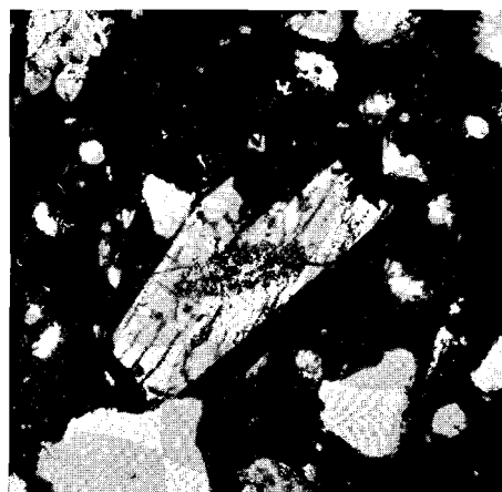
3. Phénocrystal d'augite: l'agré- gat microcristallin de pyroxène monoclinique du centre, les extré- mités (001) déchiquetées sont ca- ractéristiques des cristaux d'augite formés aux dépens de l'enstatite. 50 x. Nicols //.
