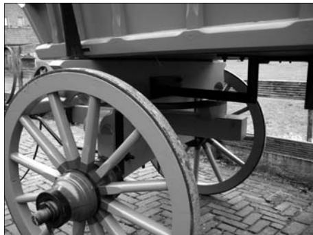
De Van Helden- constructie waardoor de vooras 360° kan ronddraaien. (Foto Jan Delfgou)
