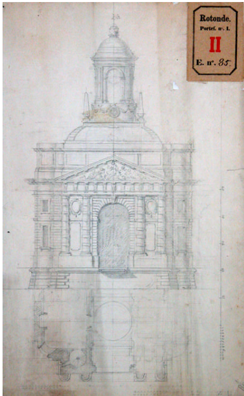
Afbeelding 6.25. P. de Swart (toegeschreven), potloodschets voor de Delftse poort, ca 1767. De plattegrond van de poort komt overeen met het in 1765 goedgekeurde plan van De Swart. De opbouw met een verdieping is hier echter vervangen door een koepelbekroning. Mogelijk laat deze tekening de gewenste vereenvoudiging van het project zien. [GAR 2002-904]
