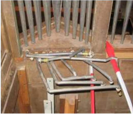
Afbeelding 32. Gecompliceerde aanleg van de conducten in het orgel van de St. Monulfus en Gondulfuskerk te Berg. Foto genomen tijdens de restauratie van het instrument in 2009, waarbij de lade tijdelijk verwijderd werd.
