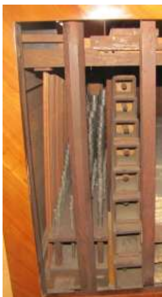
Afbeelding 33. Zijaanzicht Bureauorgel in Museum Coudenberg te Brussel met geheel links het stekermechaniek.
