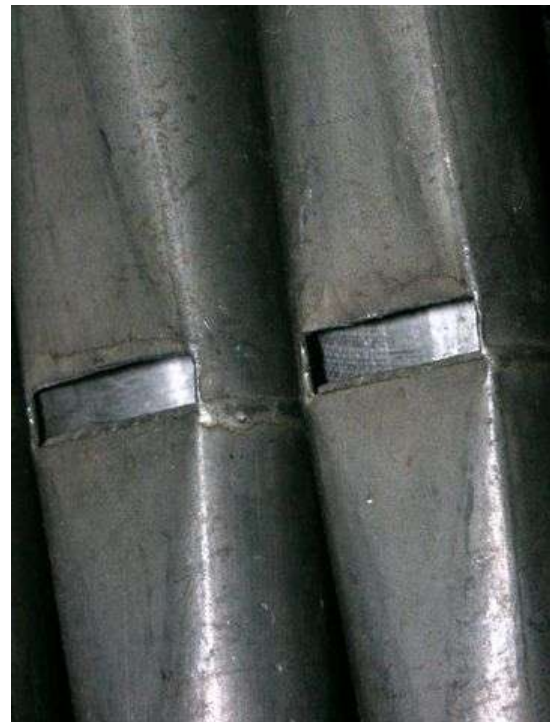
Afbeelding 39. Detail van de prestantpijpen in het Robustelly-orgel te Eckelrade met in de binnenkant afdruk van doek. Foto Verschueren Orgelbouw.
