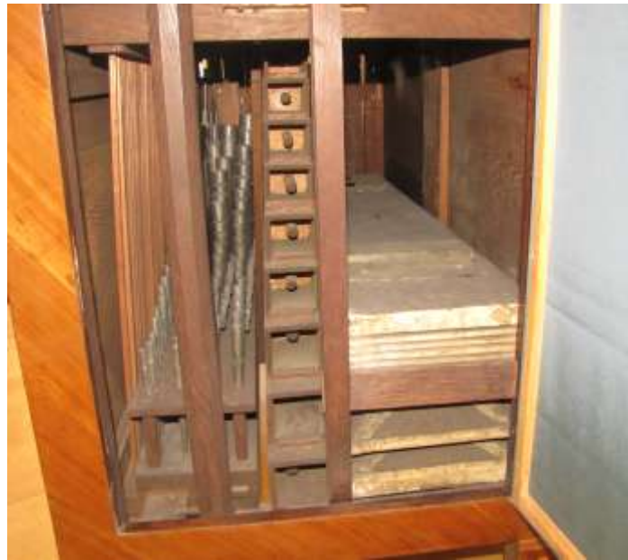
Afbeelding 30. Zijaanzicht van het bureauorgel in Museum Coudenberg te Brussel. Rechts de magazijnbalg met daaronder de schepbalg.
