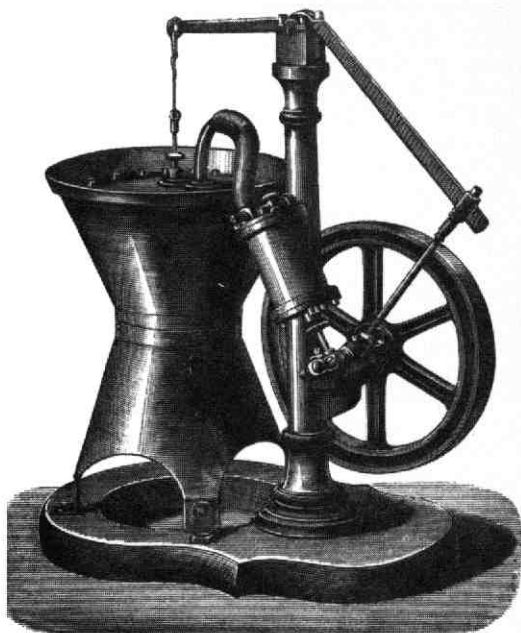
De heteluchtmotor van D. W. van Rennes. Uit: D. Harting Pzn. „De motor Rennes en de calorische pomp” in: Album der Natuur, 1877, p. 36.
