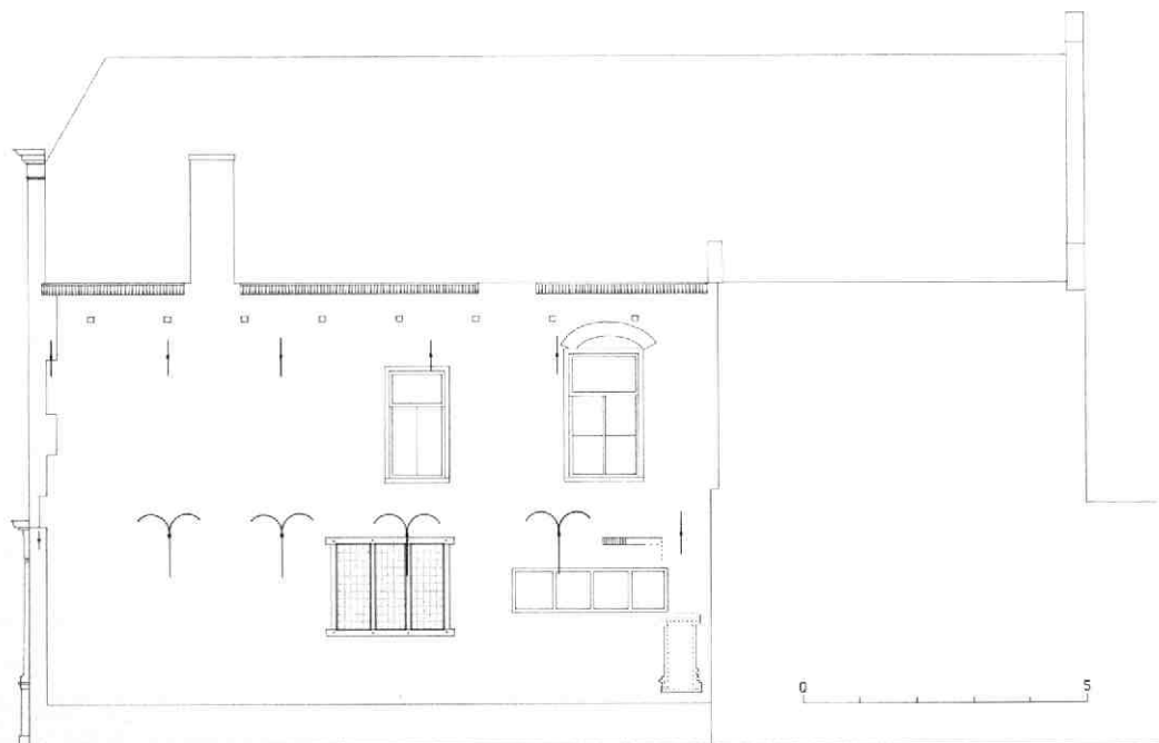
Afb. 208 Oude Gracht 177. Tek. Kees Terhorst. De 17e-eeuwse zijgevel langs de Strosteeg. Het drielichtvenster op de begane grond is omstreeks 1800 dichtgemetseld, waarbij over het kozijn „bakstenen“ en „voegen“ zijn geschilderd.
