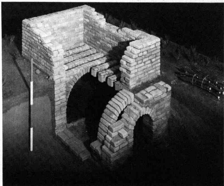
Afb. 2 Maquette (schaal 1:5) van de best bewaarde tegel-oven aan de Oudenoord/ Bemuurde Weerd, gemaakt door P. C. van Hout
