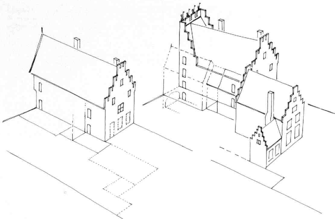
Afb. 227 Oude Gracht 307, Leeuwenberch. Vogelvluchtperspectief van het huis uit het noordwesten. Tek. A. F. E. Kipp. Links: de oorspronkelijke opzet. Rechts: na de bouw van de nieuwe voorgevel en het toevoegen van de andere bouwdelen van het complex.
