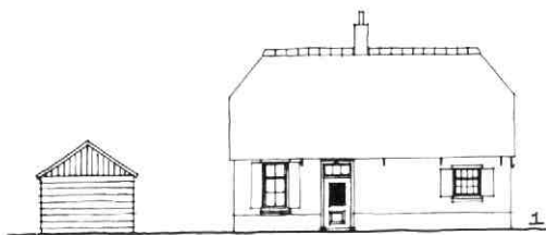
Afb. 73 Kantonnaleweg 76. Aanzicht en plattegronden. Tek. C. J. M. Rampart. 1: voorgevel. 2: plattegrond van de beganegrond met de oorspronkelijke functies van de ruimten. a: woonkeuken. b: „nette kamer“. c: woon/slaapkamer. 3: plattegrond van de zolderverdieping.
