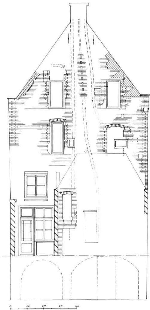
Afb. 92 Oude Gracht 319-321. De achtergevel met de resten van vijf vensters uit de 14e eeuw. Tek. D. Doyer. Met onderbroken lijn is het verloop van de rookkanalen van de oorspronkelijke schouwen aangegeven.
