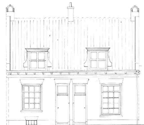
Afb. 76 Lauwerecht 92-94. Reconstructieschets van vooraanzicht en langsdoorsnede in de toestand sedert de verbouwing uit omstreeks 1800. Tek. A. F. E. Kipp.
