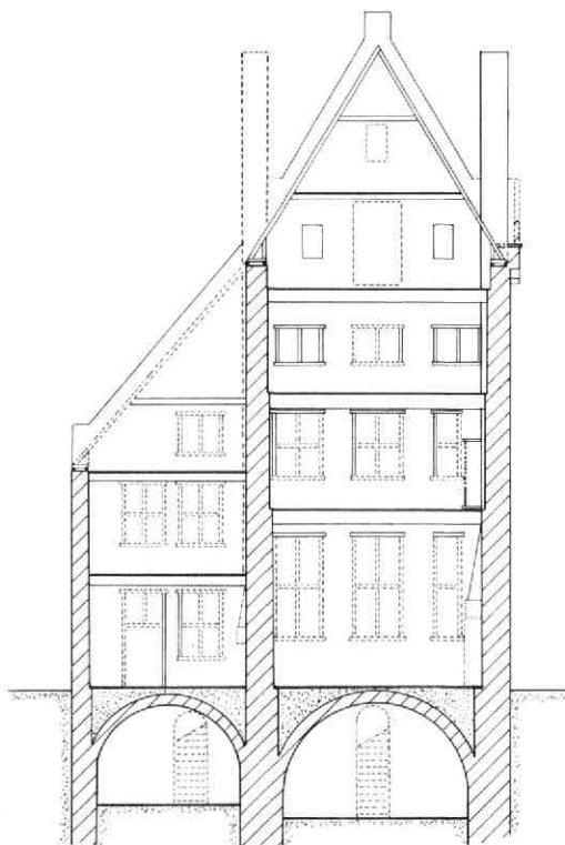
Afb. 119 Oude Gracht 219. Dwarsdoorsnede naar het westen, met reconstructie van de 14e eeuwse opzet. Tek. E. M. Kylstra.
