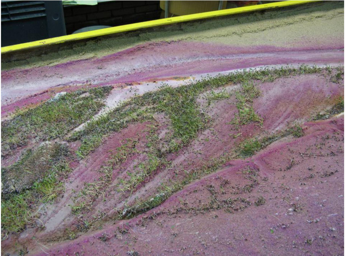
Figuur 4.3 Vegetatie in banen op een natuurlijke zandbank in een stroomgootexperiment. De witte kleur is fijn sediment (steenmeel); de paarse kleur is drooggevallen beddingsediment (zand; tijdens het experiment is kleurstof aan het water toegevoegd); de vegetatie is alfalfa (ca. 2 cm hoog). Bron: van Dijk et al. (2013).
