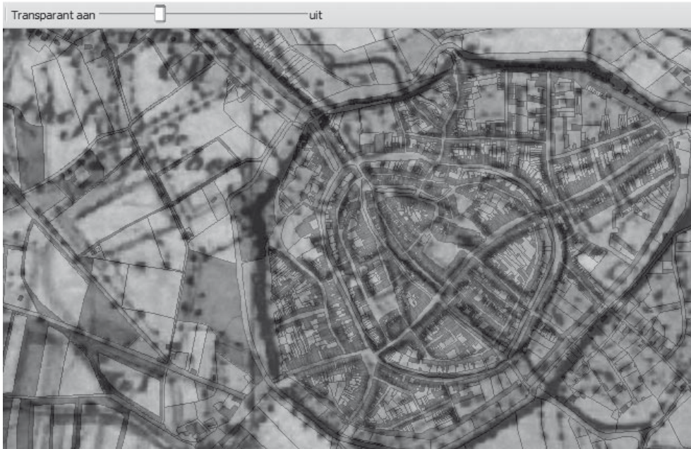
Figuur 12.3 Een schuifregelaar, waarmee de mate van transparantie van een laag kan worden ingesteld. Bron: Kadastrale Atlas Amersfoort URL8.12.
