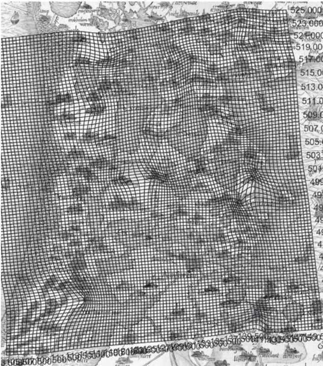
Figuur 5.10 Vervormingsgrid over de kaart van de Holland va Jacob van Deventer.
