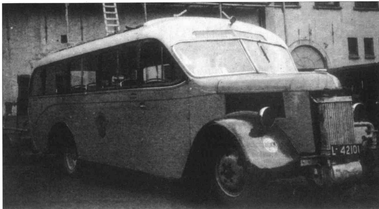
Een Opel van de Rijnstreek, de 466, staat in 1943 op de binnenplaats van de ATO aan de Moreelselaan, voorzien van een houtgasgenerator.
