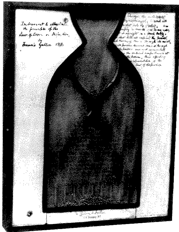
Een apparaat, genaamd de 'quincunx', ontworpen door Galton om het optreden van de normale verdeling, die hij in het onderschrift de 'law of dispersion' noemde, te demonstreren. (Tisley & Spiller, 172 Frampton Rd.)
