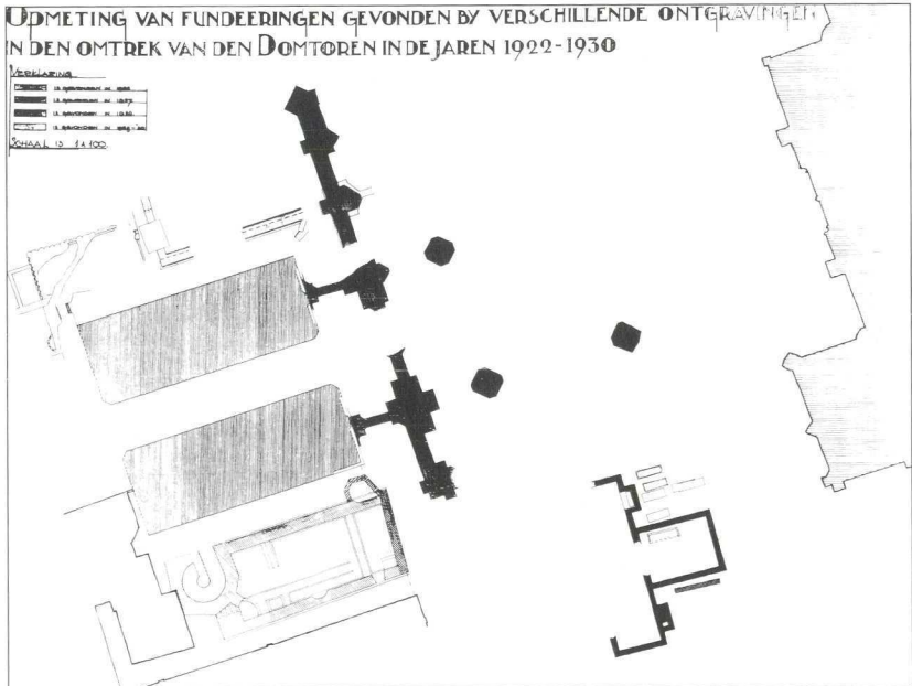
Afb. 6. Overzicht van de funderingen, gevonden bij de Domtoren in de jaren 1922-1930. De lichter getinte funderingen aan weerszijden van de Domtoren behoren tot de romaanse Dom; de donkere in het midden zijn van het gotische schip en de Heilig-Kruiskapel. Tekening W. Stooker. Foto: RDMZ, nr. 56961.
