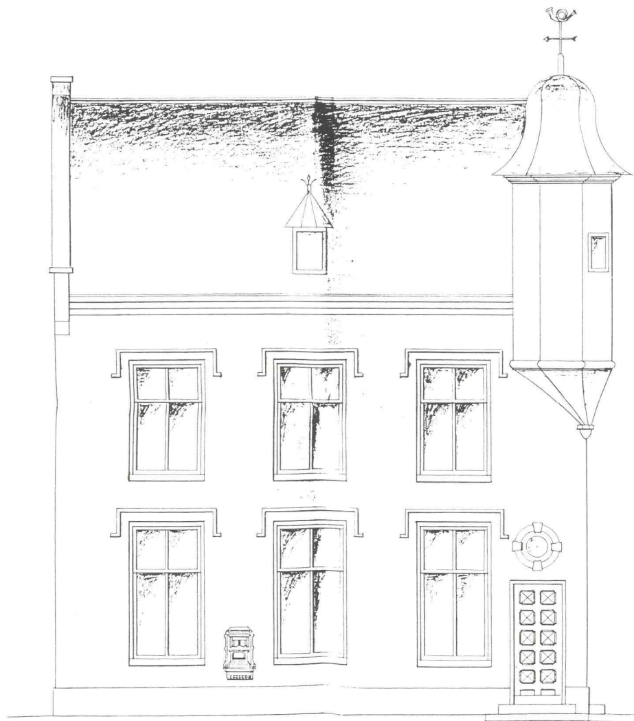
Afb. 4. Tekening, in 1883 gemaakt door de timmerlieden D.J. van Santen en M. van de Grampel, van de voorgevel van het in Breukelen te bouwen post- en telegraafkantoor. De verticale streep en de lichte golvingen in de lijnen in het midden van de tekening zijn veroorzaakt door een vouw in het bestek, waar deze tekening deel van uitmaakte.
