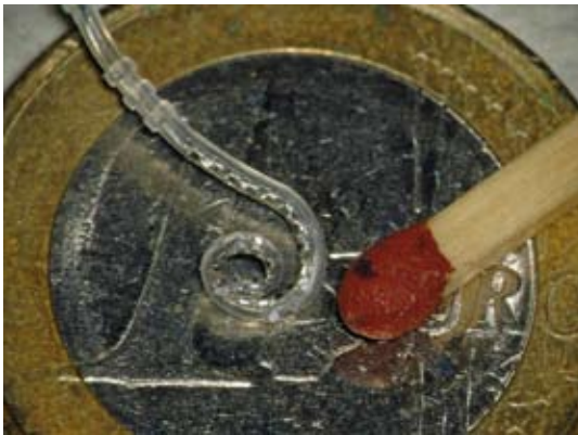
Figuur 5: Foto van de elektrode van een cochleair implantaat om de grootte te illustreren
