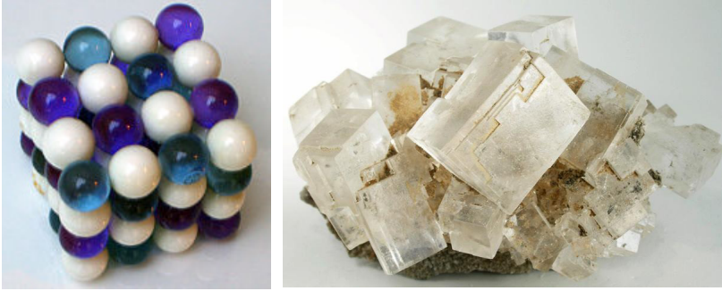
Figuur 10.2 – (a) met behulp van knikkers kun je een kubusvormig kristal bestaande uit 2 verschillende atomen (zoals NaCl) gemakkelijk nabouwen (wit = atoom nr. 1, gekleurd grijs = atoom nr. 2). (b) Wanneer een zoutkristal heel langzaam groeit (bijvoorbeeld in een zoutmijn) kunnen hele grote kubusvormige NaCl kristallen ontstaan.
