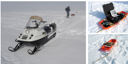
Figuur 1: Sneeuwscooter met GPR systeem. De transmitter van het radarsignaal bevindt zich op de achterste slede, het signaal wordt ontvangen en opgeslagen op een computer op de voorste slede. De antennes bevinden zich voor, achter en tussen de sledes.
