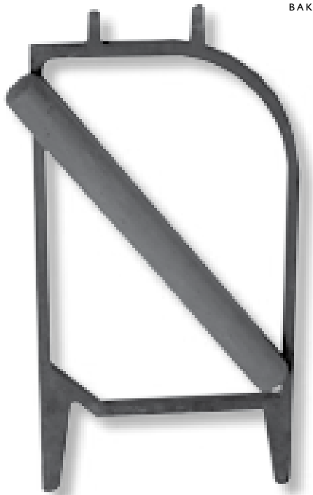
Ijzeren raamwerk waar de klei in werd “gekletst” door de pannenkletser met afstrijkstok (er blijft wel eens wat aan de strijkstok hangen...) Bron: Nederlands Dakpannenmuseum
